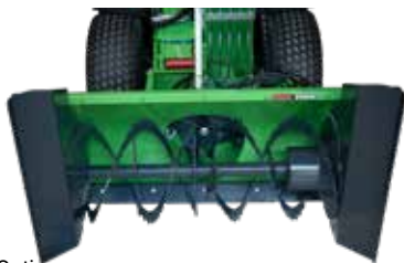
Fraise à neige équipée d'élargisseurs de côté
