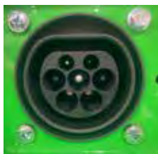
Standard Type 2 ladekontakt på laster
