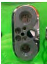
Conector de carga opcional trifásico DIN 320 en la cargadora, A464123
