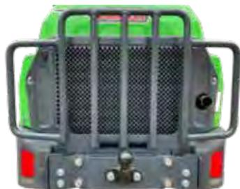
El parachoques trasero protege la parte trasera y el radiador del motor. Se monta con cuatro pernos y es fácil de instalar y desinstalar. Está equipada con soportes de sujeción y permite montar los contrapesos traseros y/o el acoplamiento del remolque al mismo tiempo.
